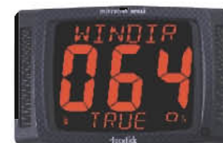
单数据显示(T210) 屏幕字体尺寸：50mm
